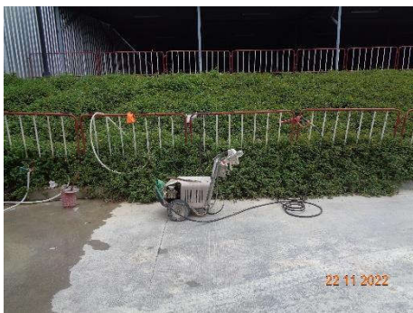
ภาพที่ 2.2-7 อุปกรณ์สำหรับฉีดล้างล้อ
